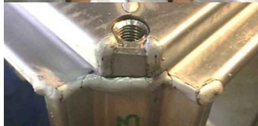
Сварные швы рамы, сваренной импульсным режимом в новом защитном газе
