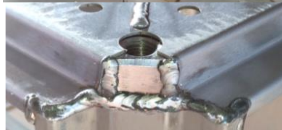
Сварные швы рамы сваренной вручную в защитном газе
