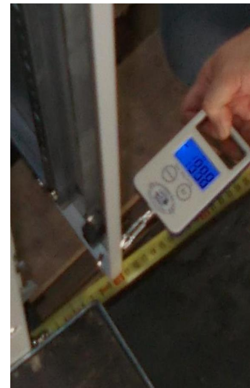
Дверь «Провенто» в момент нагрузки
